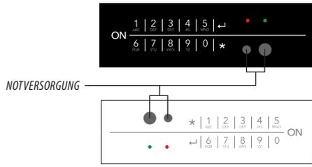
Das Schloss wird durch eine rechteckige 9 Volt Blockbatterie mit Strom versorgt. Die Batterie soll ins schwarze Batteriefach an der Unterseite der Tastatur gestellt werden.
